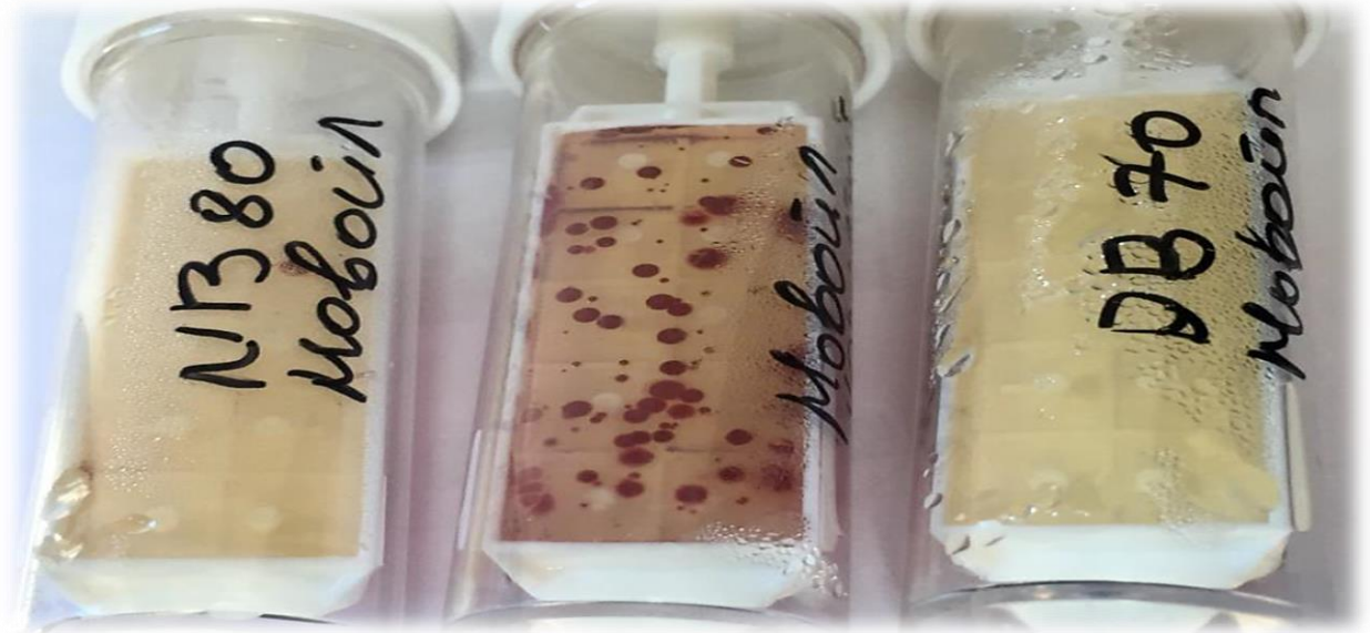
Рисунок 15 – Дип-слайд после обработки воды водоблока №1 реагентами ECOTECH.
