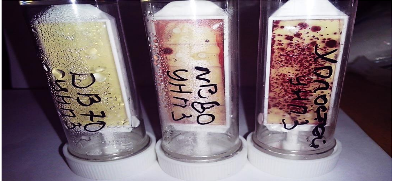
Рисунок 14 – Дип-слайд после обработки воды водоблока №4 реагентами ECOTECH
